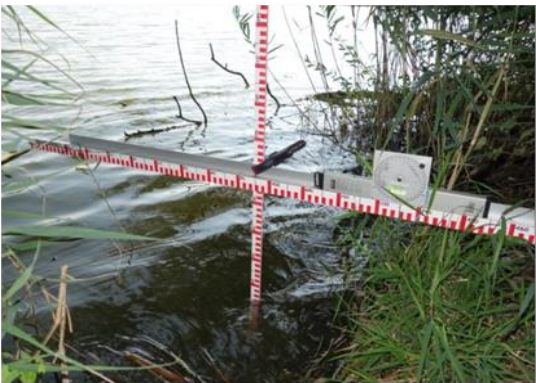
Abb. 18: Bestimmung der Uferhöhe
