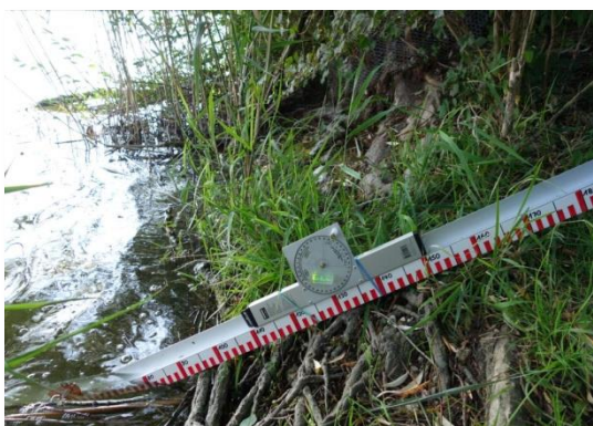
Abb. 20: Bestimmung der Uferneigung (Gefälle)
