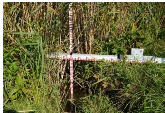
Abb. 19: Bestimmung der Uferhöhe (bei Ausstieg)
